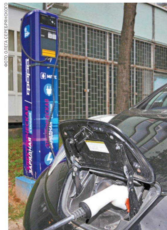
Кабель во время зарядки никто не вытаскивает, пока владелец не разблокирует его с помощью мобильного приложения.
