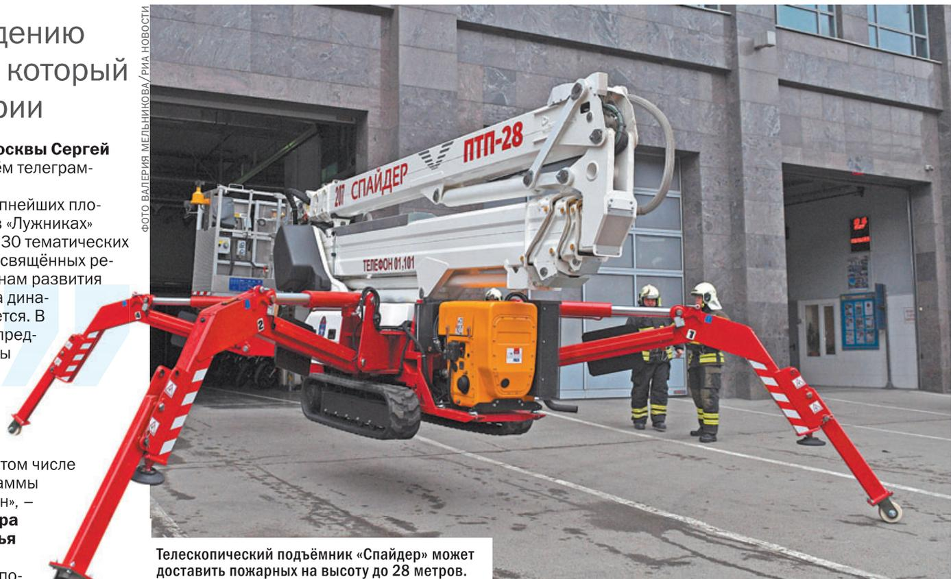
Телескопический подъёмник «Спайдер» может доставить пожарных на высоту до 28 метров.
