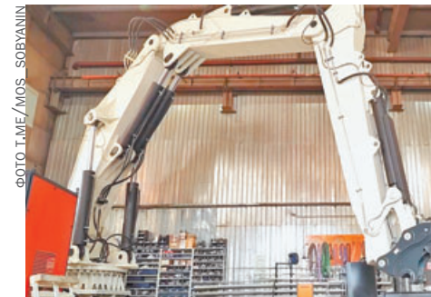
Такое оборудование называется «бутобой», он измельчает крупные куски породы.
